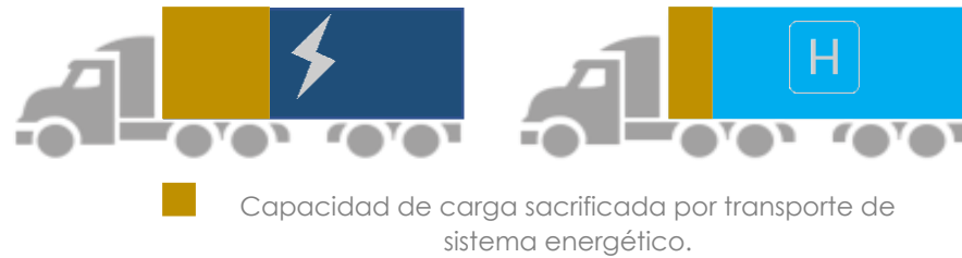
Figura 1-7 Comparación entre la capacidad de carga en HDV de BEV y FCEV
