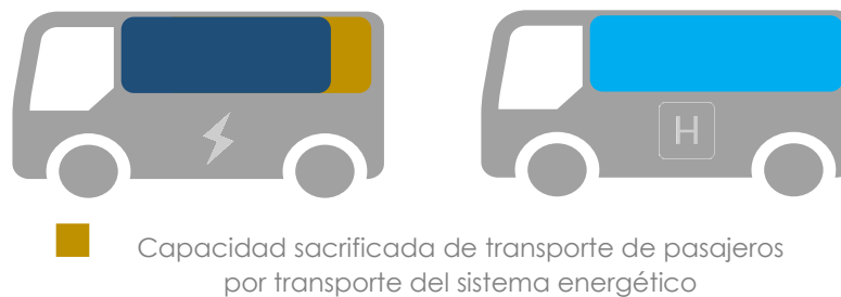
Figura 1-6 Comparación entre la capacidad de transporte de pasajeros en buses BEV y FCEV
